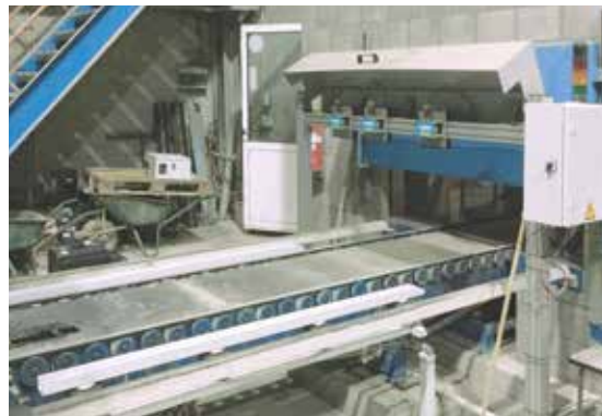
Steinhöhenmessung mit Brettverwiegung
