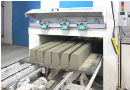
Steinhöhenmessung von Bordsteinen
